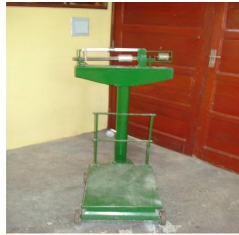
Balança com capacidade para 300 kg
